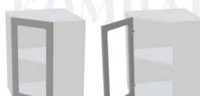
Корпус: ШВУ600 / ШВУС600 600x718x600 (ШxВxГ) Фасад: ШВУС600 420x715x16 (ШxВxГ) - 1 шт.
